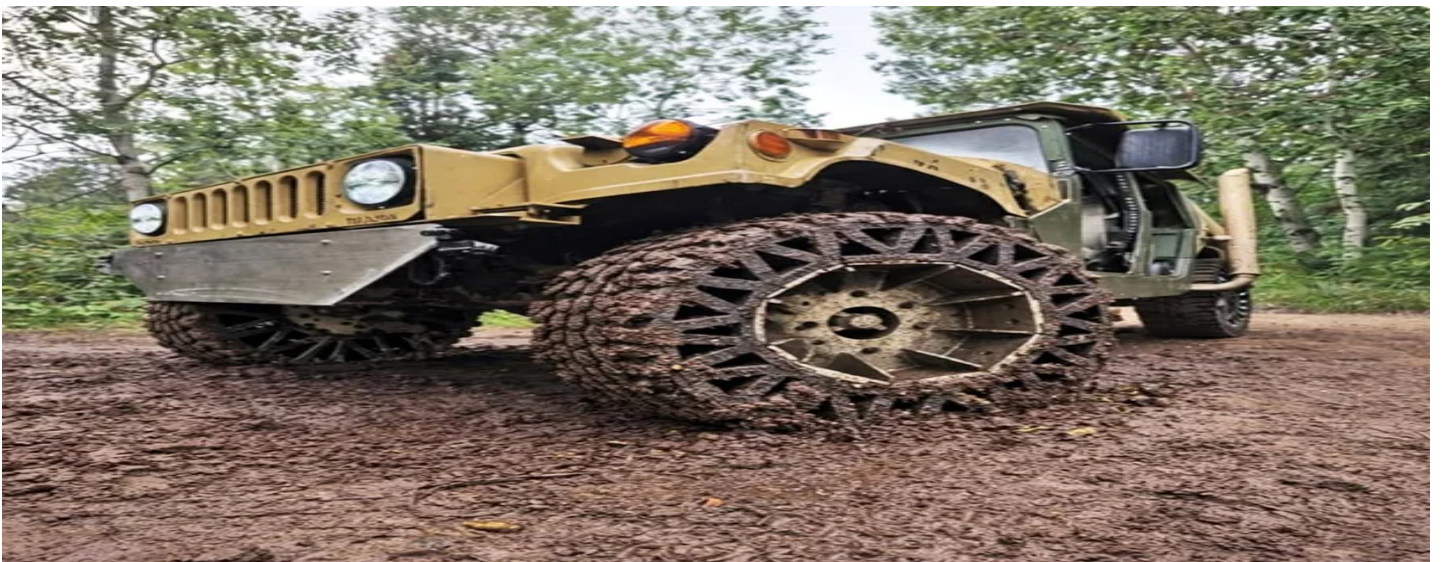
Ruote da Combattimento a Segmenti: l'innovazione che cambia la mobilità militare
